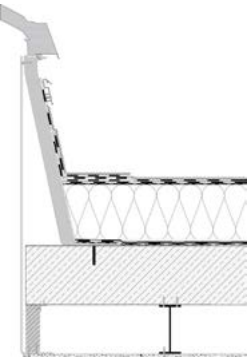
Příklad 2: Obložení stropní konstrukce vč. manžety. Vhodné pro pevná zasklení.
