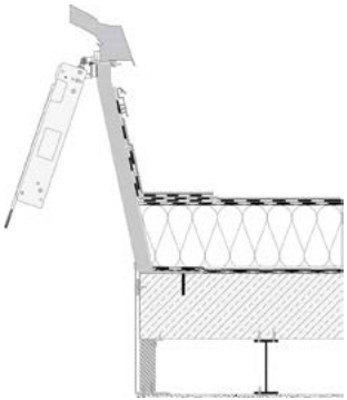
Příklad 1: Obložení stropní konstrukce bez manžety. Vhodné pro větratelnu a pevná zasklení.
