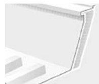
Manžeta s trapézovým plechem Výška 30 cm
